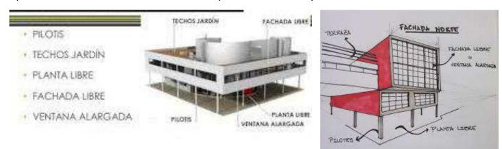
Los pilotes, la cubierta jardín, la planta libre, las ventanas horizontales y la fachada libre, permitidos por el uso de la tecnología moderna y en particular por el hormigon armado.
